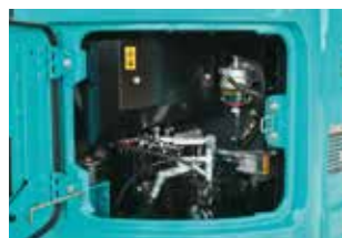
Het brandschot scheidt het pomp-compartiment van de motor
