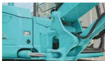
Zwenkstuk: Groot, dik gietijzeren zwenkstuk
