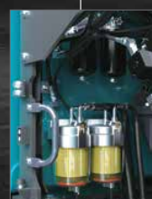
Voorfilter met ingebouwde waterafscheider
